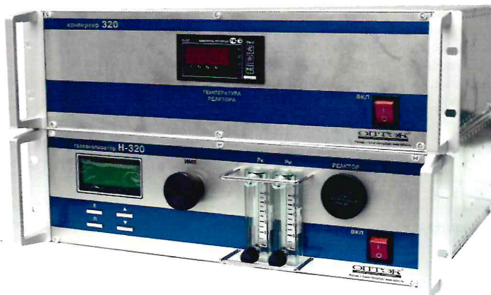
Фото 1 - Внешний вид газоанализатора мод. Н-320
