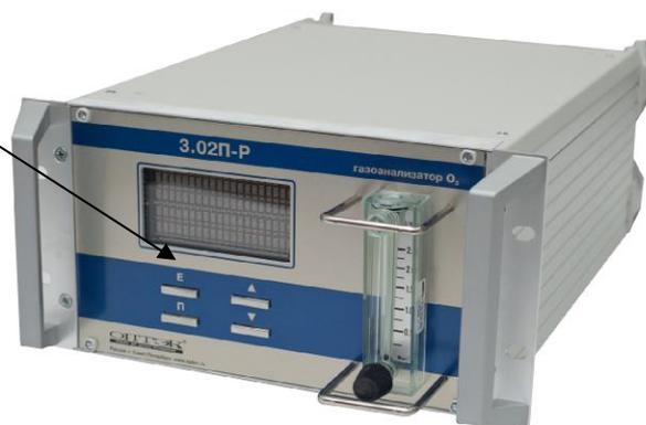
Рисунок 2 – Общий вид газоанализатора 3.02П-Р
