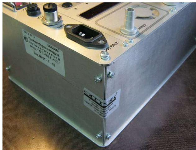
Рисунок 3 - Пломбировка ОП-М
